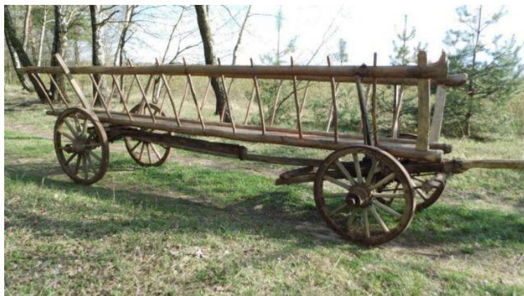
Żelaźniaki wyposażone w długie drabiny służyły do przewozu snopów zboża lub siana
